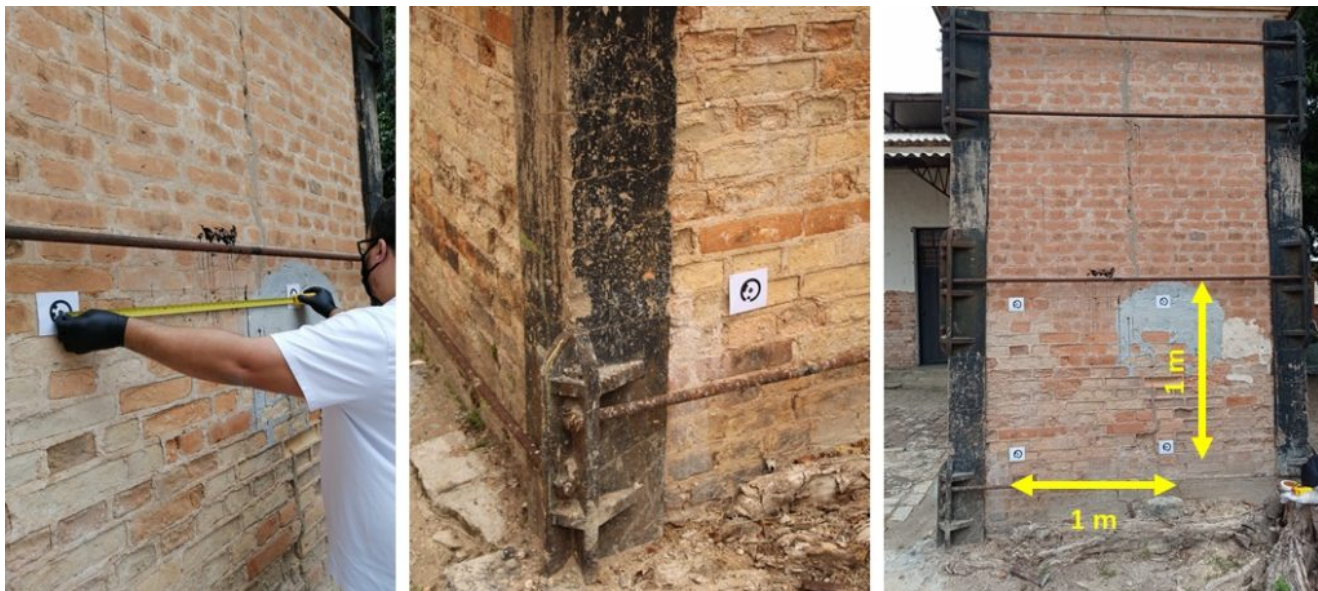
Fig. 5. Medição e fixação dos alvos na fachada posterior da fornalha, 2021 (fonte: Acervo pessoal dos autores).
